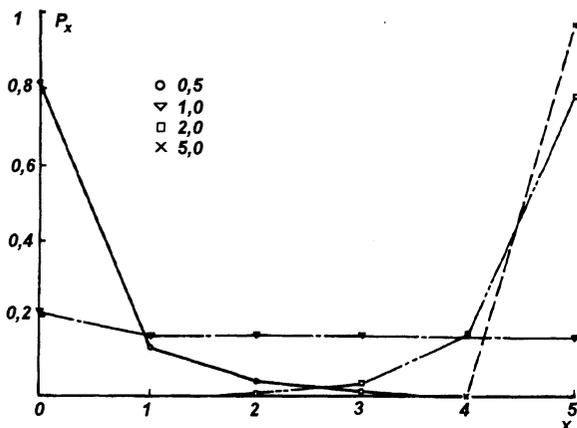
Рис. 10. Вероятность того, что в буфере находятся  $x$  требований. Дисциплины  $d^*$ , FIFO, интенсивности пуассоновского трафика  $\lambda = 0, 5; 1; 2; 5$
